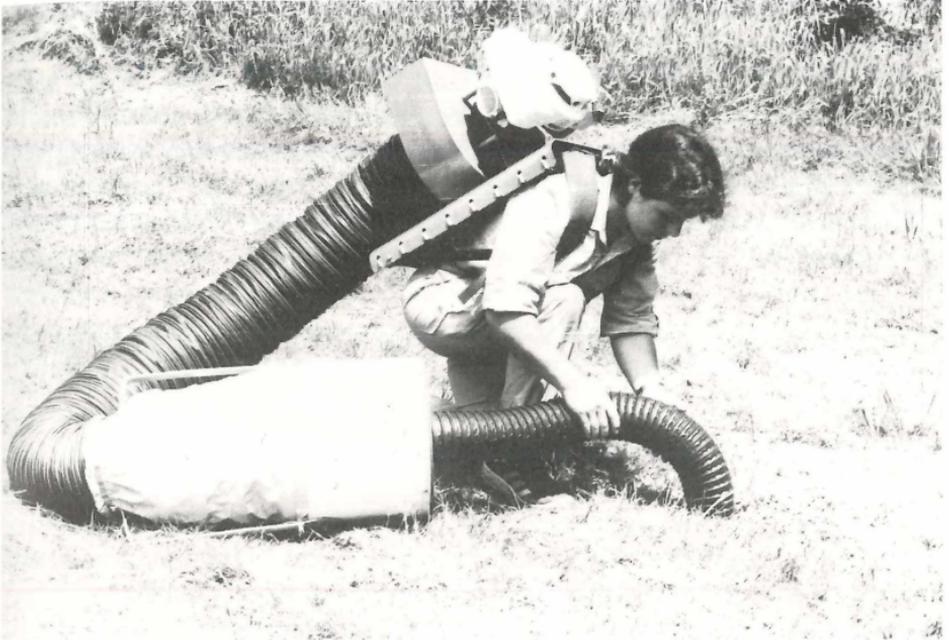
*Abb. 7: Einsatz des „vacuum-insect-net“ (D-Vac) zum Absammeln von Arthropoden in der Krautschicht und auf der Bodenoberfläche. Das Gerät arbeitet nach dem Prinzip des Staubsaugers und wird mit einem Zweitaktmotor betrieben. Die eingesaugten Tiere bleiben lebend in einem Netzeinsatz hängen und können später aussortiert werden.*
