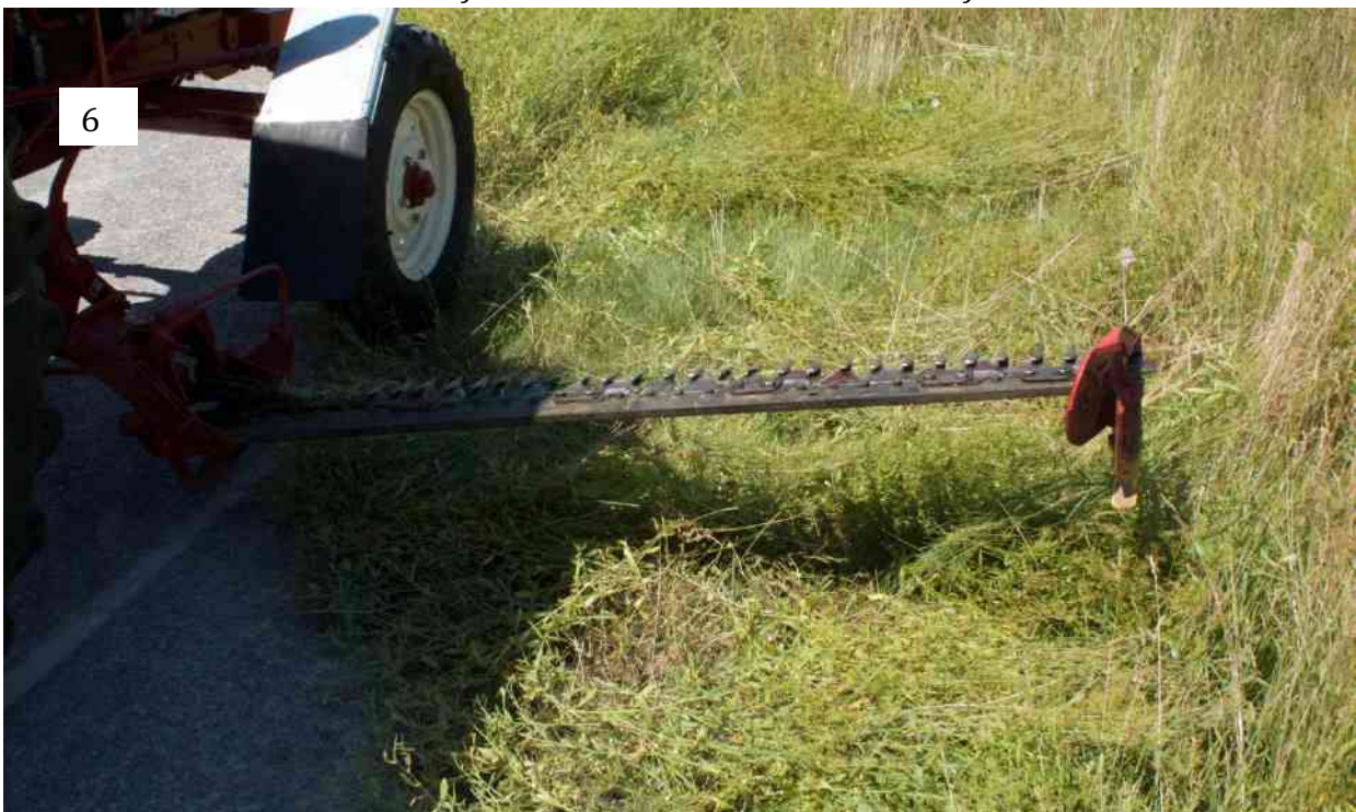
Abb.6: Das beste Arbeitsgerät für diese Biotop-Pflege ist ein bejahrter Trecker und ein Balkenmähwerk. Das schlechteste ein Kreiselmäher der neuesten Bauart. Gemäht wird hier noch im Schritttempo und mit einem ausreichenden Bodenabstand des Mähbalkens.
